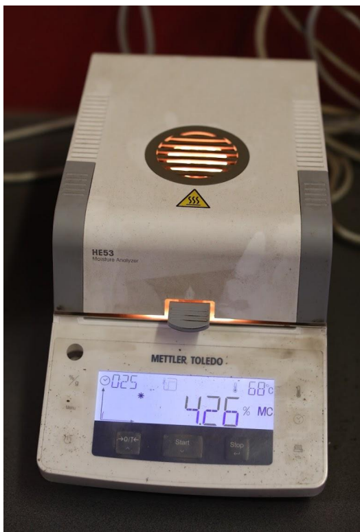
Joonis 7. Niiskuse mõõtja Moisture Analyser HE53 (Klaos, 2022)
