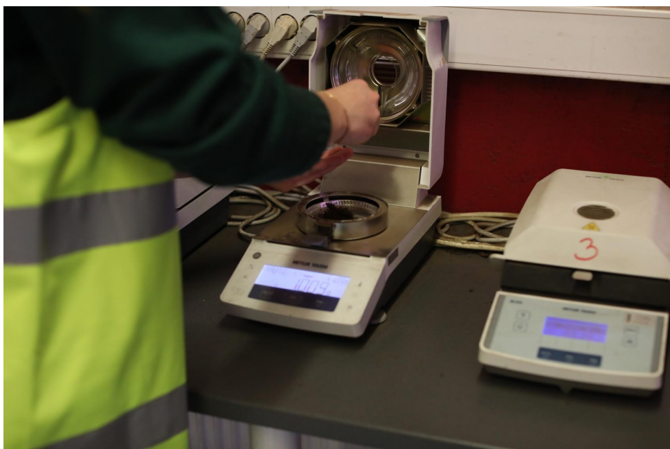
Joonis 8. Töö autor turba niiskust mõõtnas (Klaos, 2022)
