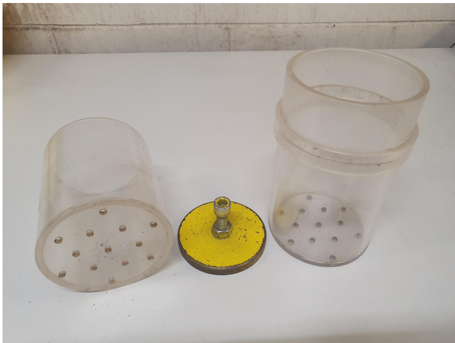
Joonis 1. Cen-1 liitri mõõtesilindri osad (silinder, raskus ja krae) (Vaarmets, 2023)
