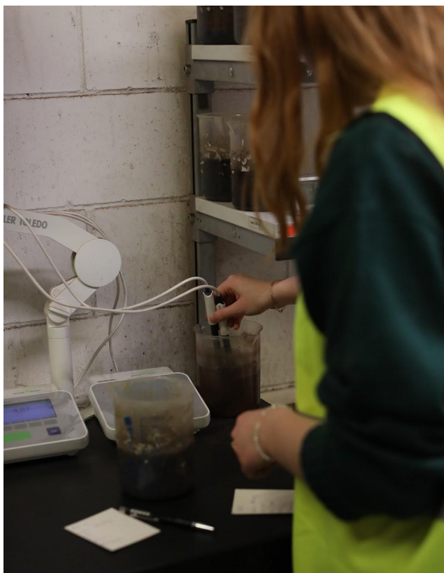
Joonis 6. Töö autor mõõtnas happesust ja elektrijuhtivust (Klaos, 2022)
