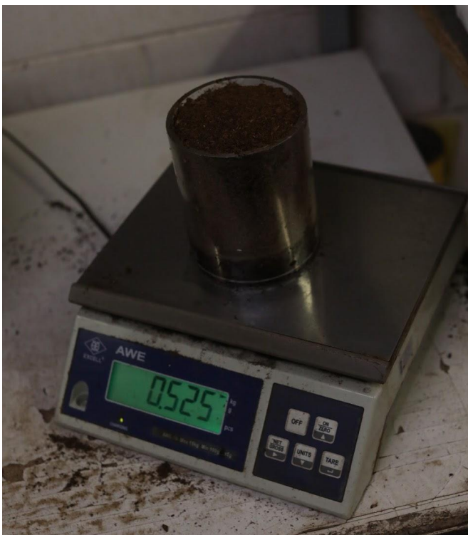
Joonis 10. Turba kaalumine peale vee imendamist (Klaos, 2022)
